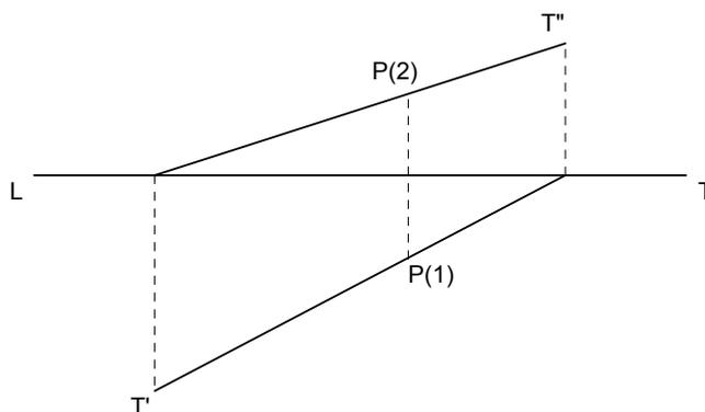
Si definisce “retta di profilo” una retta le cui proiezioni coincidano con una stessa retta perpendicolare alla linea di terra; si prova allora che condizione necessaria e sufficiente affinché un punto appartenga ad una retta non di profilo è che la prima proiezione del punto appartenga alla prima proiezione della retta e la seconda proiezione del punto appartenga alla seconda proiezione della retta (se la retta in questione è di profilo, la condizione enunciata è solo necessaria).
